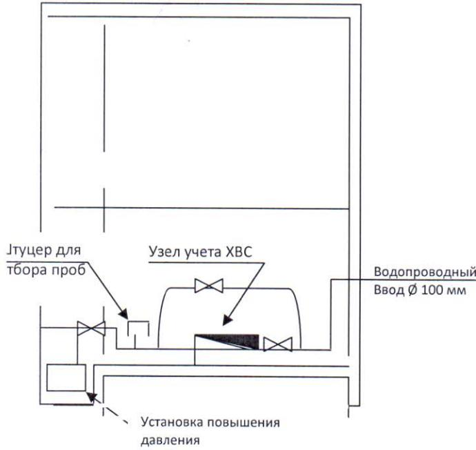
1. Схема узла учета холодной воды соответствует техническим условиям.
